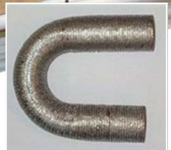
Rør pålagt Inconel og derefter koldbukket
