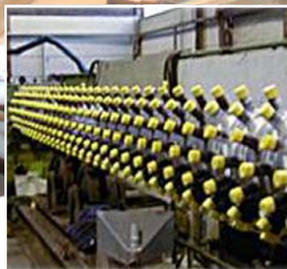
Samler fremstillet i x10CrMoVNb9-1, ASTM SA 235
