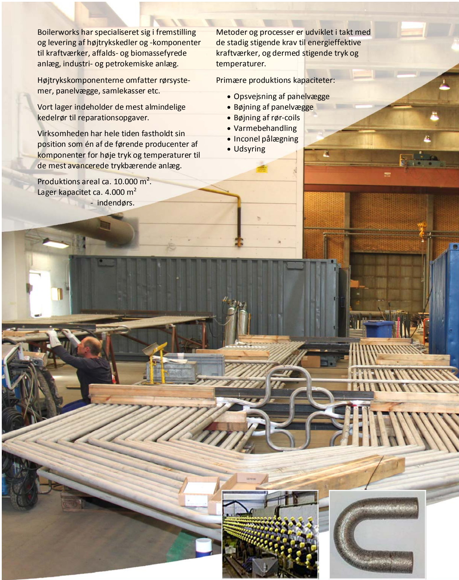
Samler fremstillet i x10CrMoVNb9-1, ASTM SA 235
